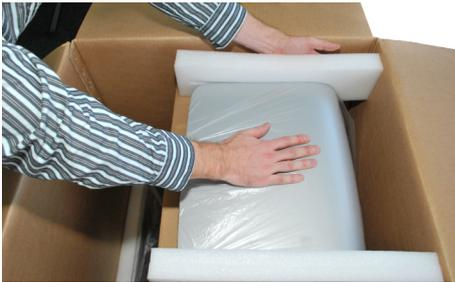
*Abb. 15: Kunststoffelemente am Kopf der Scaneinheit entnehmen*
