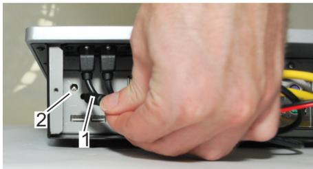
Abb. 37: Stromversorgungskabel mit Panel-PC verbinden
