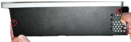
Abb. 33: Blende vom Panel-PC demontieren
