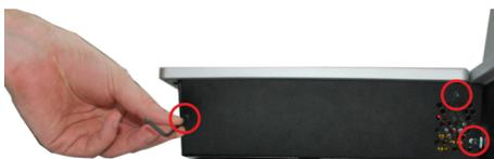
Abb. 39: Blende am Panel-PC befestigen
